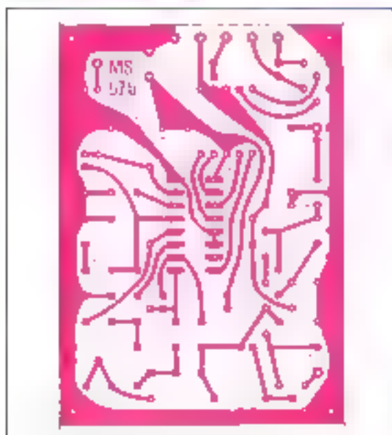
Fig. 9a - Circuit imprimé côté soufure
